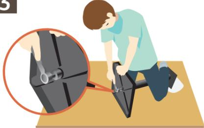
ソケットレンチでボルトをしっかり締めます。
